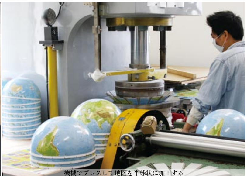
機械でプレスして地図を半球状に加工する
